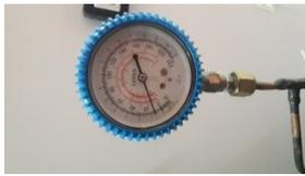
Gambar 6. pressure gauge pada tabung evaporator
