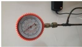
Gambar 7. pressure gavage pada tabung kondensor
