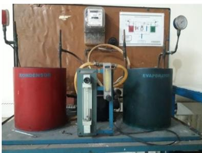
Gambar 1. Mesin *Heat Pump Water Heater* sebelum perbaikan
