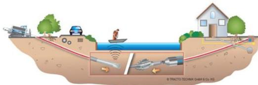
Gambar 3. Ilustrasi Metode Instalasi HDD
