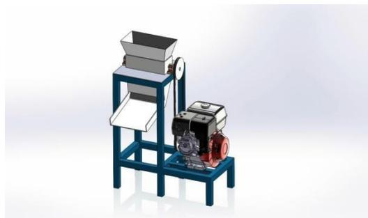
Gambar 3. Konsep Desain Mesin Pencacah Sampah Sabut Kelapa yang dirancang
